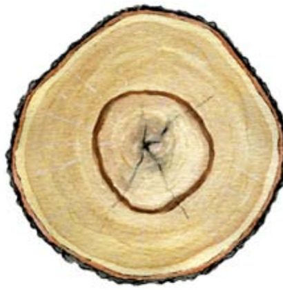
Mörk dubbelsplint. Längdavgång 0,5 m.
