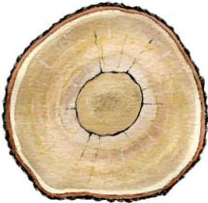
Ring- och stjärnspricka. Längdavgång 1 m.
