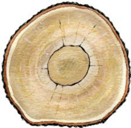
Ring- och stjärnspricka. Längdavdrag 1 m.
