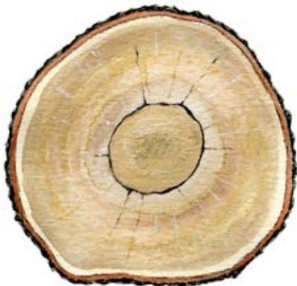
Ring- och stjärnspricka. Längdavidrag 1 m.
