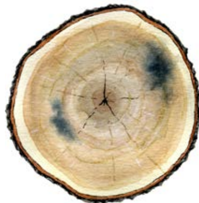
Metallskada. De blå/svarta fläckarna tyder på metallskada, om så är fallet vrak.
