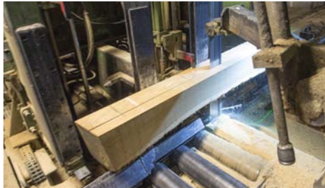
Kährs sågverk i Blomstermåla är specialiserade på att såga grovt ektimmer. I genomsnitt sågas tre kubikmeter i timmen, berättar produktionsledare Mikael Karlsson.
