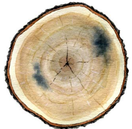
Metallskada. De blå/svarta fläckarna tyder på metallskada, om så är fallet vrak.
