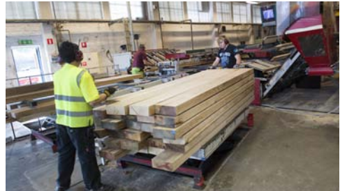
Kährs sågverk i Blomstermåla är specialiserade på att såga grovt ektimmer. I genomsnitt sågas tre kubikmeter i timmen, berättar produktionsledare Mikael Karlsson.
