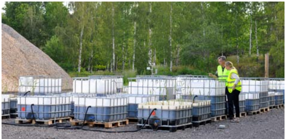
I en stor pilotanläggning på fabriksområdet sker tester för hur dagvattnet, som används vid bevattning av ektimmer, kan renas för att minska framtida miljöpåverkan.
