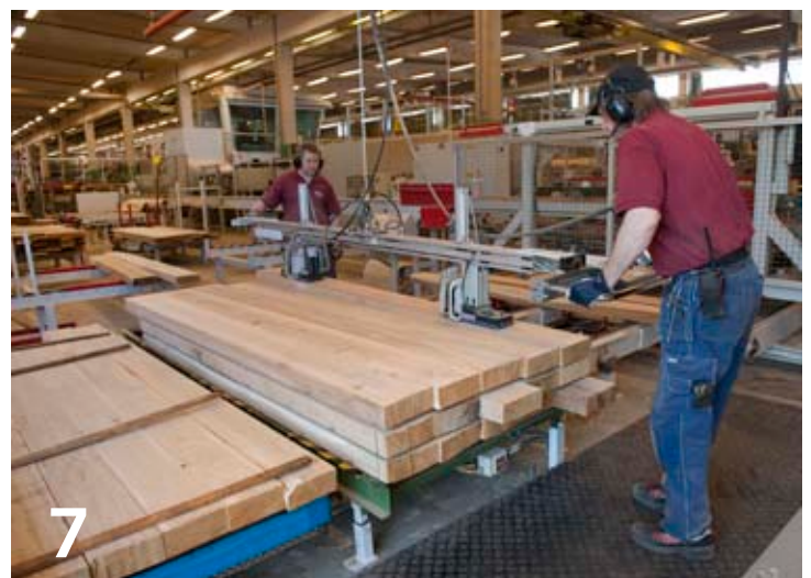
Slutligen fördelas sågat ekvirke i paket före torkning.
