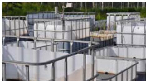
I en stor pilotanläggning på fabriksområdet sker tester för hur dagvattnet, som används vid bevattning av ektimmer, kan renas för att minska framtida miljöpåverkan.
