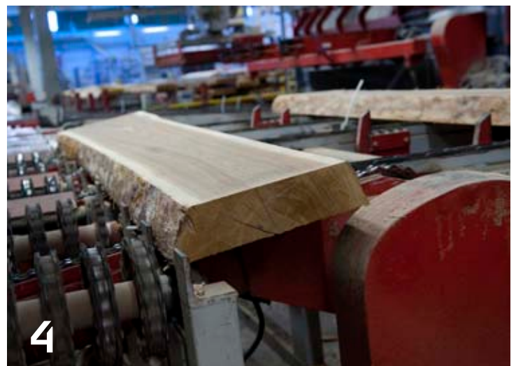
Ett block på 80 millimeter ger 13 golvsnitt, vilket motsvarar ungefär sex kvadratmeter färdigt trägolv.
