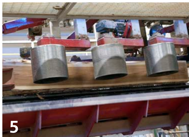
De första sidobräderna på stocken sågas fram i reducerbandsågar innan de transporteras till kantverken.
