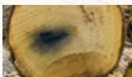
Skada av metall, till exempel en spik.
