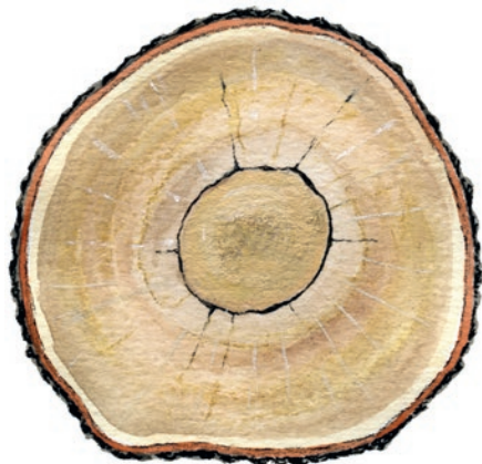
Ring- och stjärnspricka. Längdavgdrag 1 m.
