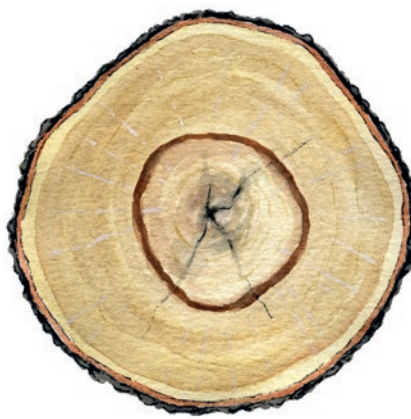
Mörk dubbelsplint. Längdavgdrag 0,5 m.
