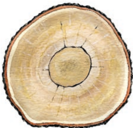
Ring- och stjärnspricka. Längdavrdrag 1 m.
