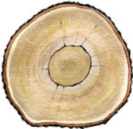
Ring- och stjärnspricka. Längdavdrag 1 m.
